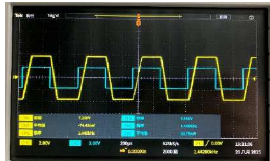
圖二十八、I Gain 積分 clock 速度 200kHz
