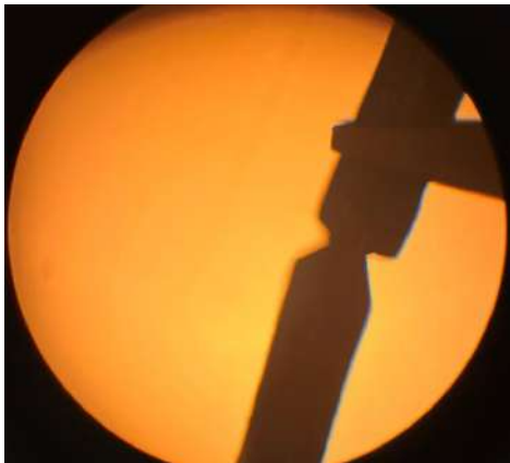
圖（四十八）：為本部分於線材上的切口範例圖片
