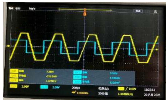
圖二十九、I Gain 積分 clock 速度 100kHz
