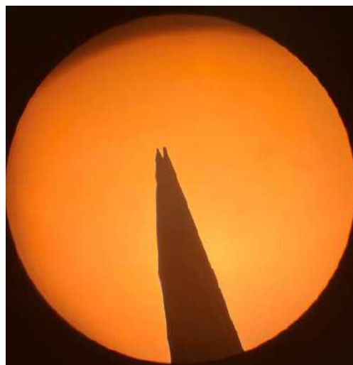
圖（五十七）：為直接切斷的失敗案例在五十倍放大鏡下的成果
