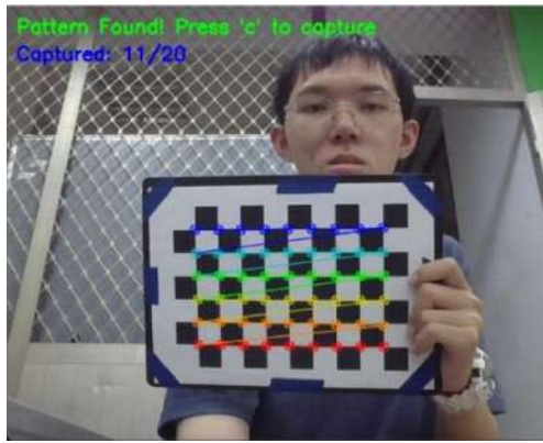
圖 2：鏡頭棋盤式相機校正
