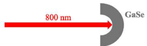
圖 4-6 曲面硒化鎵基頻光入射角 0 度之示意圖。
